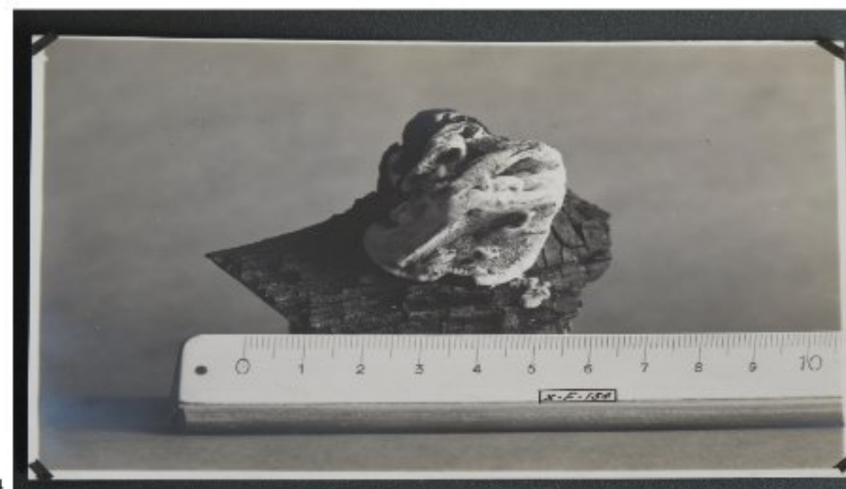
3. Frammenti di tubi lignei a protezione dei chiodi dello scafo, inviati a Cormio nel luglio 1938. Archivio della Civica Siloteca Cormio, Museo civico di storia naturale, Milano, fascicolo 40.
