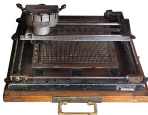
10. Macchina Constançon per la scrittura Braille.
